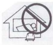
Устанавливайте компрессор в тени и хорошо проветриваемом месте. Срок службы мембран и клапанов в компрессоре может быть сокращен при достаточно высокой температуре, вызванное тепло солнечных лучей. При установке компрессора на открытом воздухе, не забудьте защищать его от атмосферных осадков.
